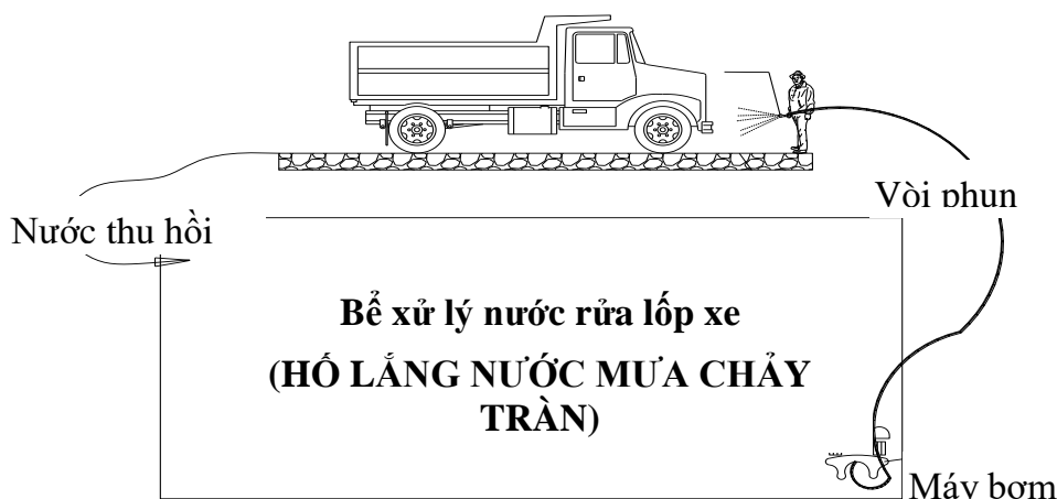
Hình 3.6. Sơ đồ nguyên lý bể xử lý nước rửa xe
