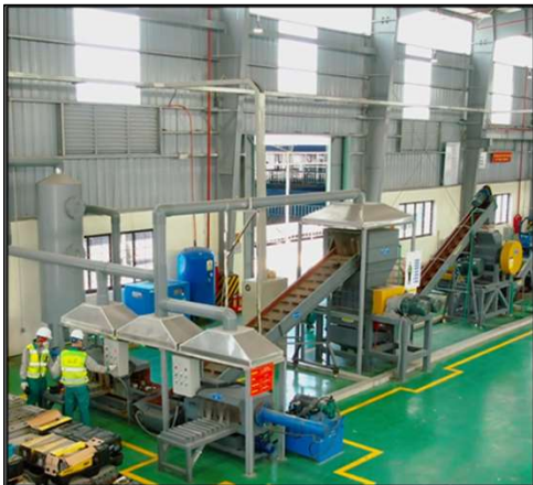
Bố trí hệ thống hút mùi tại khu vực tiếp nhận, phân loại
