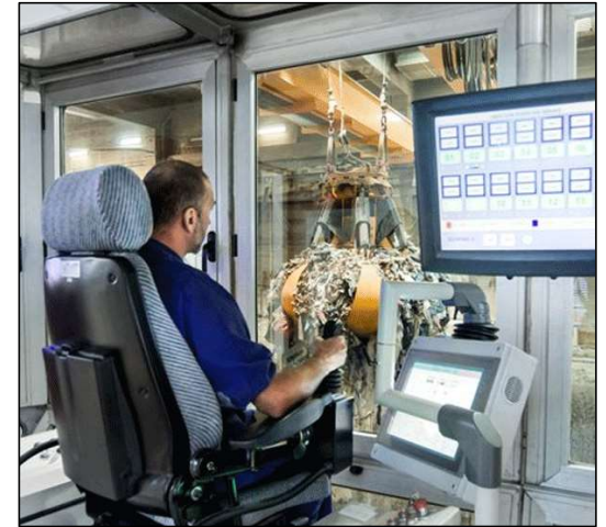
Cán bộ điều khiển từ xa cầu trục để cấp rác vào lò đốt trong phòng kín không mùi
