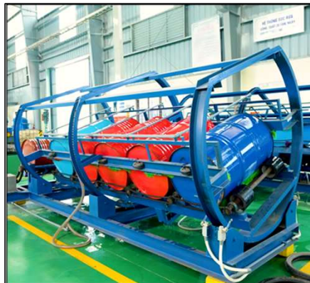
Thu hồi hóa chất và làm sạch bên trong, bên ngoài thùng phi
