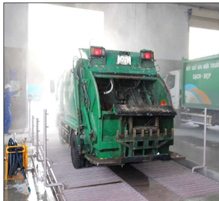
Xe rác được rửa khi ra/vào trạm
